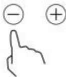
\* Если вы не выберете параметр нагрева в течение 1 минуты, индукционная варочная поверхность автоматически выключится. Снова начните с действия 1.
