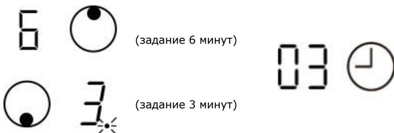
Чтобы проверить уставку времени другой зоны нагрева, нажмите на клавишу выбора зоны нагрева. Таймер отобразит ее уставку времени.
