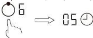
2. После завершения отсчета таймера соответствующая варочная зона автоматически выключится.
